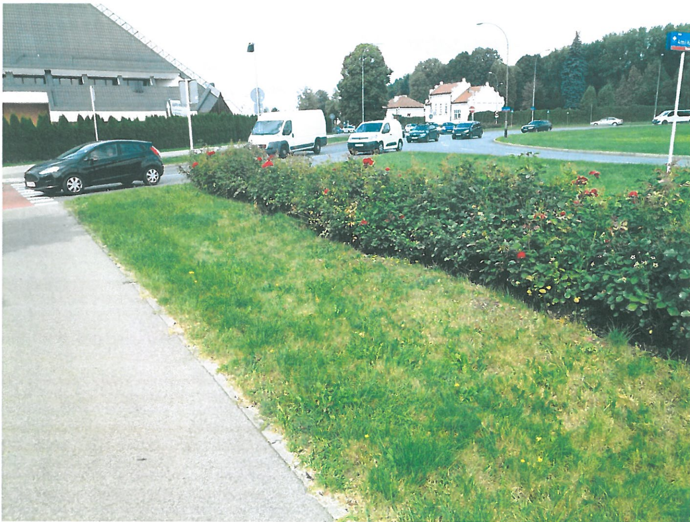
Rysunek 1. W przypadku rowerków dziecięcych, przyczepek rowerowych, oraz sportowego samochodu z niższym polem widoczności, te róże na 4 wylotach z ronda wpływają negatywnie na właściwe pole widoczności oraz poczucie bezpieczeństwa.
